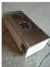
DK-98-II означает: контроллер температуры с одним цифровым светодиодным экраном (вместо старого контроллера температуры стрелочного измерителя)
